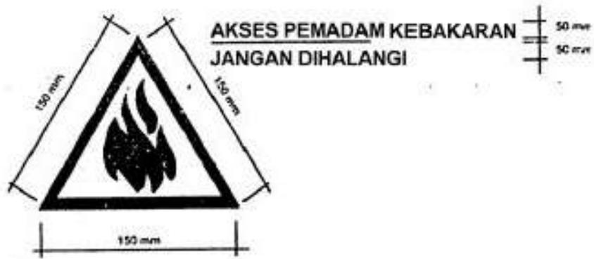
Gambar 10 Tanda bukaan (gambar dan tulisan berwarna merah) ditempel di sisi sebelah dalam
