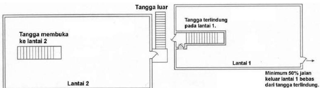
Gambar 41 Bagian terlindung dari tangga yang sudah ada
