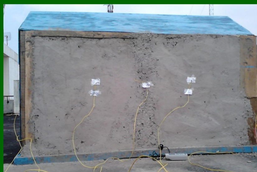
Gambar 4. Uji termal miniatur bangunan
