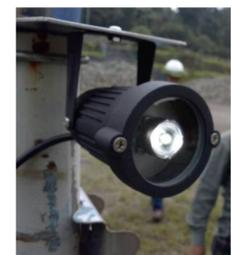
Gambar 8. Lampu LED untuk menerangi alat ukur di *wellhead* sumur panas bumi
