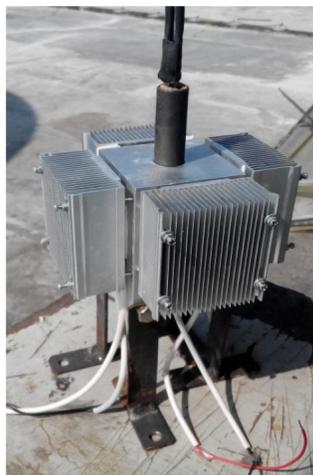
Gambar 4. Sistem TE pada pengujian di laboratorium
