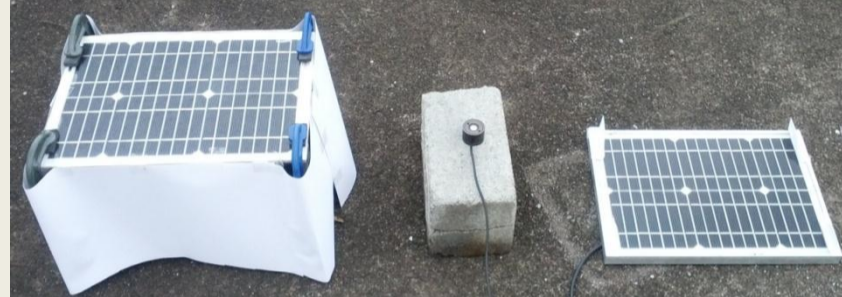
Gambar 4 Pengujian performa panel surya berpendingin di rangka
