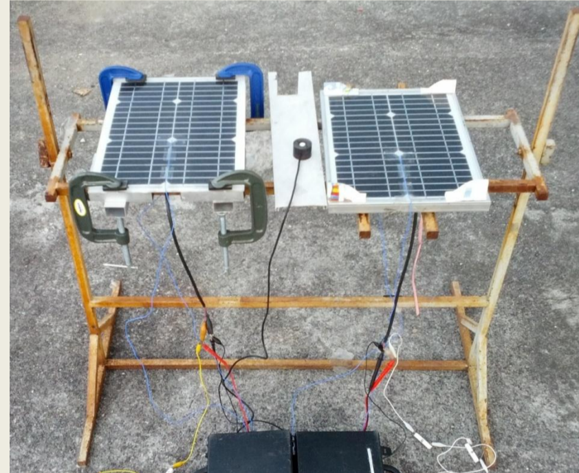
Gambar 4 Pengujian performa panel surya berpendingin di rangka
