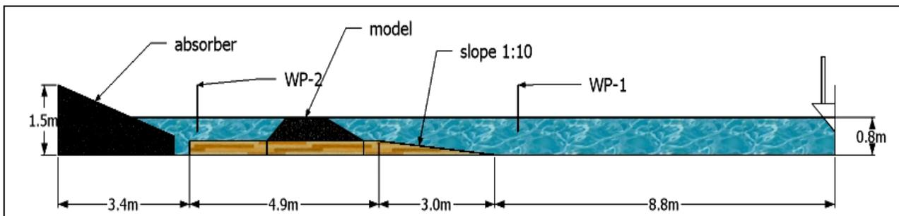
Gambar 1. Detail flume tank dan penempatan *wave probe*
