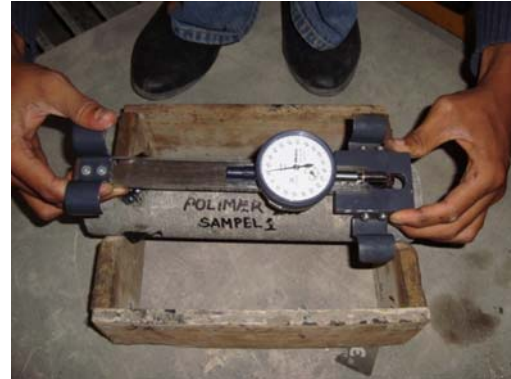
Gambar 7. Susunan demec point pada benda uji non-komposit dan komposit (tampak atas) serta pelaksanaan pengukuran susut pada benda uji
