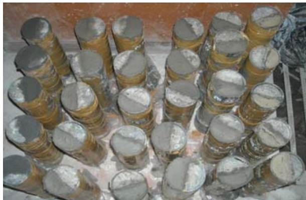
Gambar 6. Pencetakan benda uji komposit
