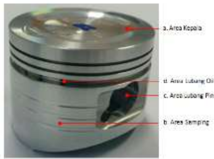
Gambar 3 Pembagian Area Piston
