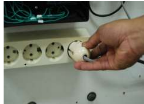
Gambar 15. Steker MCB ke terminal steker
