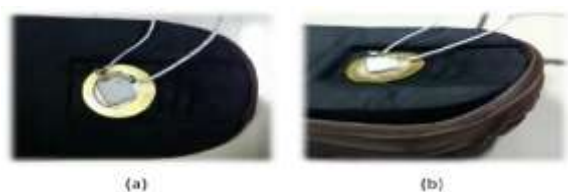
Gambar 7 Realisasi Konfigurasi Piezoelektrik Audio Generik (a) Tampak Atas (b) Tampak Samping
