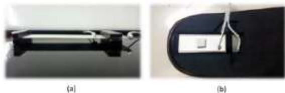
Gambar 6 Realisasi Konfigurasi K7520BP2 (a) Konstruksi K7520BP2 (b) Konfigurasi K7520BP2 di dalam Sol
