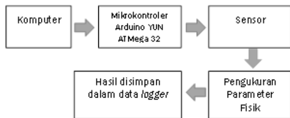
Gambar 1 diagram alir pengukuran parameter fisik laut
