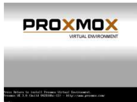
Gambar 4. Tampilan awal instalasi Proxmox
