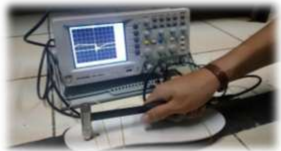
Gambar 4 Pelaksanaan Uji Menggunakan Impact Hammer
