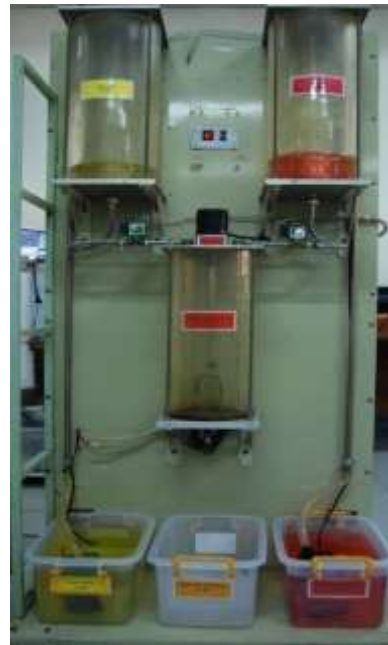
Gambar 20. Proses aliran fluida warna pada Simulator fluid-mixing
