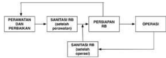
Gambar 3 peralihan mode pengoperasian sistem tata udara RB [5]
