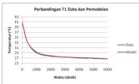
Gambar 40 Kurva Perbandingan Temperatur 1 Data Riil Plant dan Pemodelan
