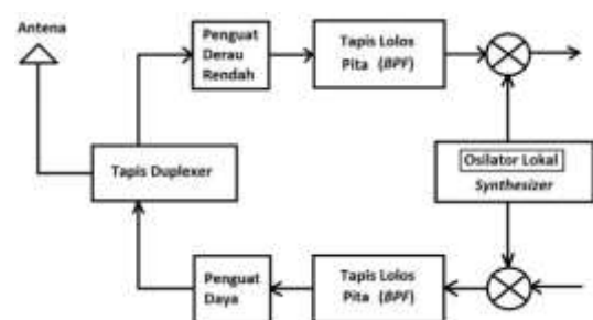
Gambar 1. skema pemancar penerima nirkabel yang umum digunakan
