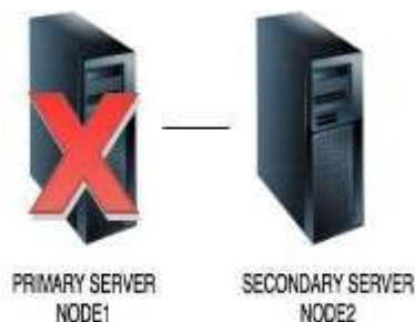
Gambar 8. Failover pada node1 dan node2
