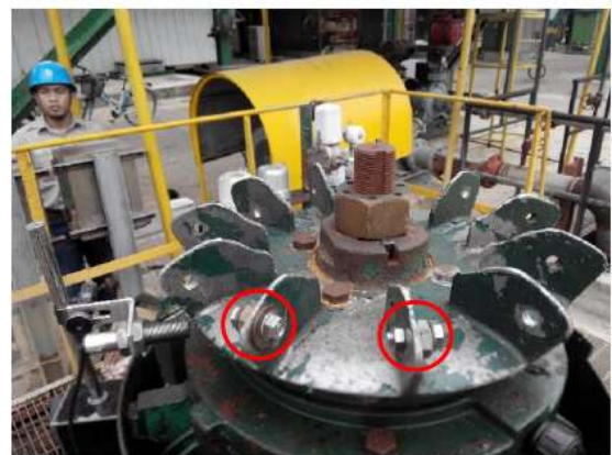
Gambar 7 Massa balancing pada blade motor
