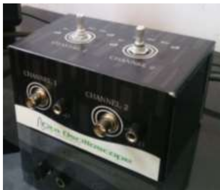
Gambar 25. Osiloskop digital dengan casing alumunium
