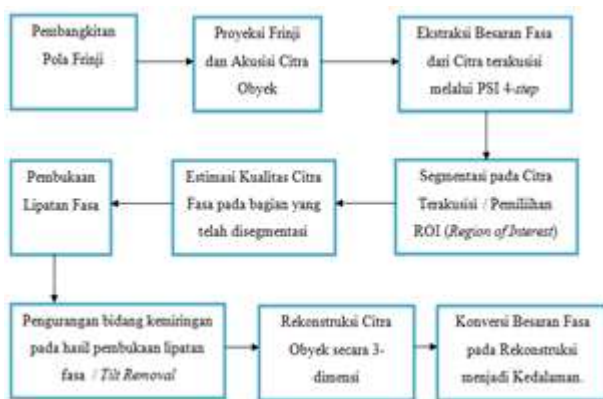
Gambar 1. Diagram alir penelitian profilometri frinji digital untuk rekonstruksi profil permukaan wajah secara 3-dimensi
