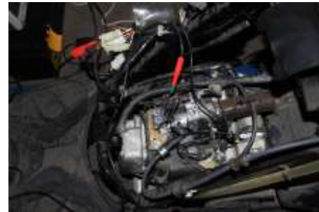
Gambar 2. pemasangan probe untuk pengambilan data
